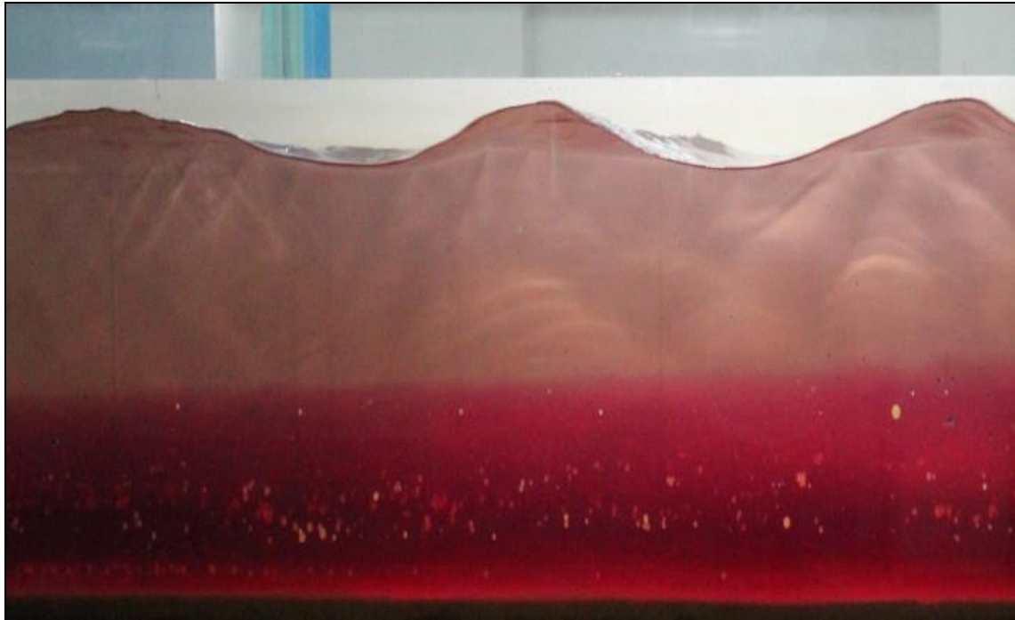
图 3.1-1b 风、浪、流、咸耦合试验水槽
