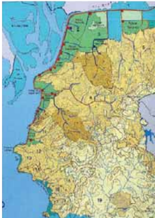
Figura 6.11. Ciudad de Porto Alegre junto al Delta de Jacuí y del Lago Guaíba. El escurrimiento de las áreas verdes es bombeado hacia el Guaíba cuando el dique las protege contra las inundaciones. Las áreas marrones escurren por gravedad y por conductos bajo presión.
