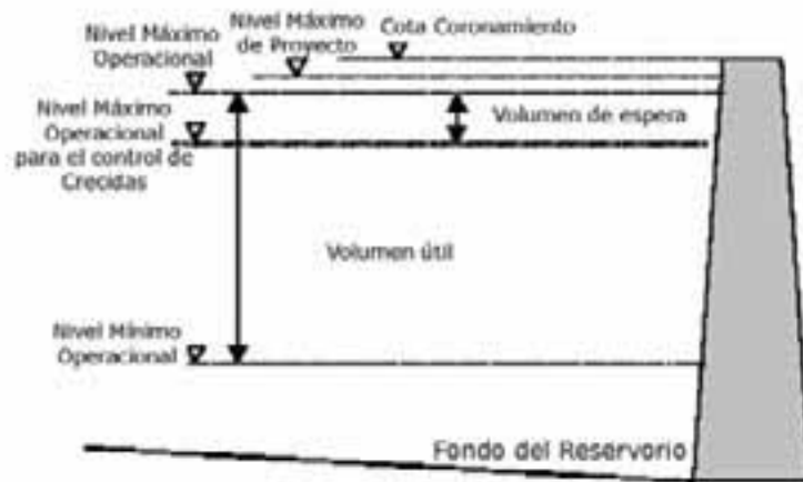
Figura 2.11. Niveles operacionales de una presa.
