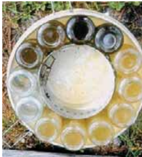
Figura 3.12. Muestrario de la calidad del agua pluvial. En el inicio de la precipitación botella marrón (posición del reloj a 45min).
