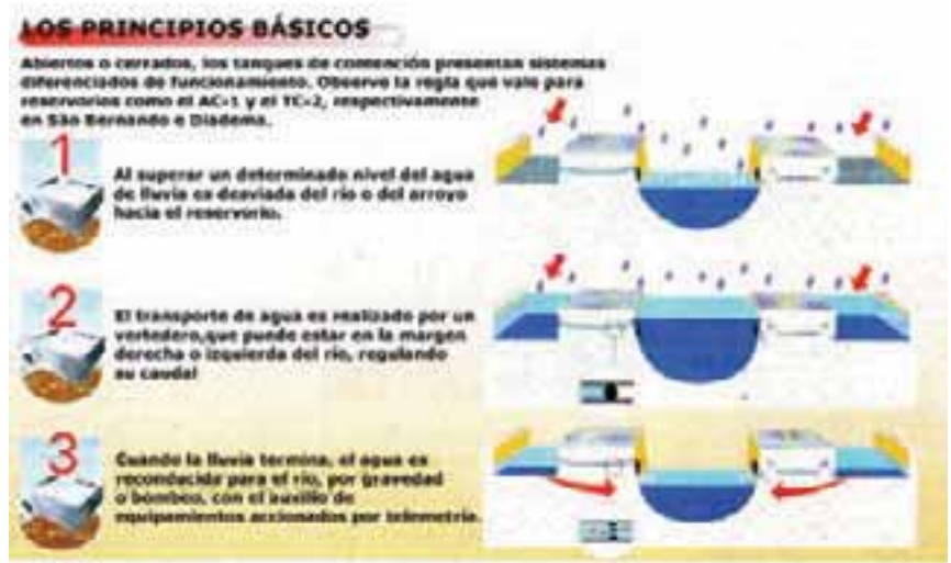
Figura 3.33. Detención off-line con volumen lateral (DAEE)
