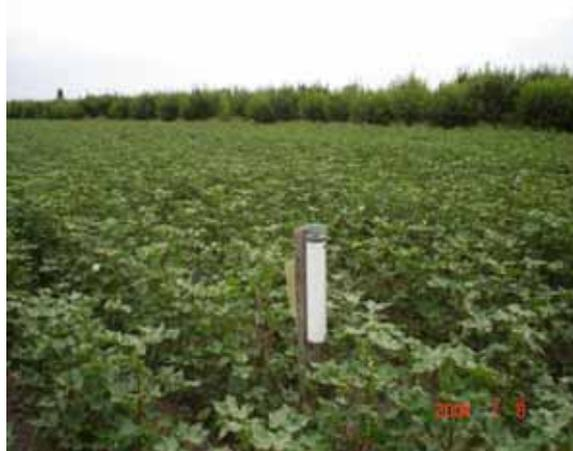
**Испаритель типа «Atmometers» (ET gage®)**
