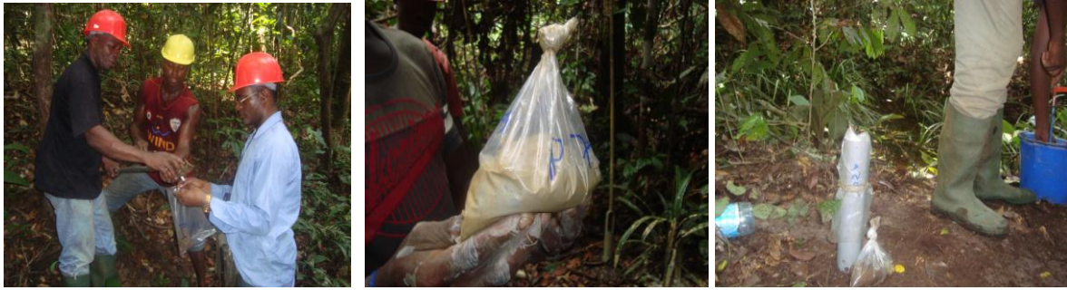
Figure 53 : Fonçage, collecte de cuttings et équipement des piézomètres
