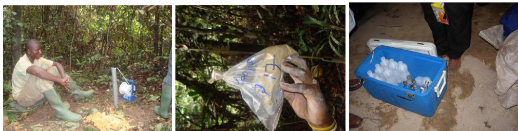
Figure 55 : Suivi piézométrique et échantillonnage des échantillons de sol et d'eau
