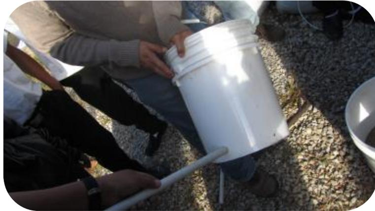
5. Se colocó silicón por dentro y por fuera de la abertura realizada, buscando sellar el agujero y evitar que goteara.
