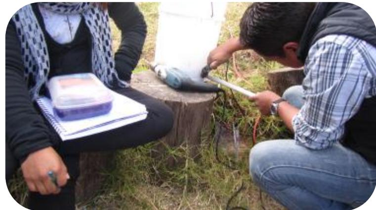
6. Se fabricó el primer filtro prueba utilizando partes iguales (alrededor de 5 cm) de los materiales filtrantes. Se colocó una capa de piedrín, seguida por una capa de cedazo. Luego una capa de granza fina, seguida de una capa de cedazo. Se colocó la granza gruesa, seguida de una capa de cedazo. Finalmente se colocó una capa de piedrín.
