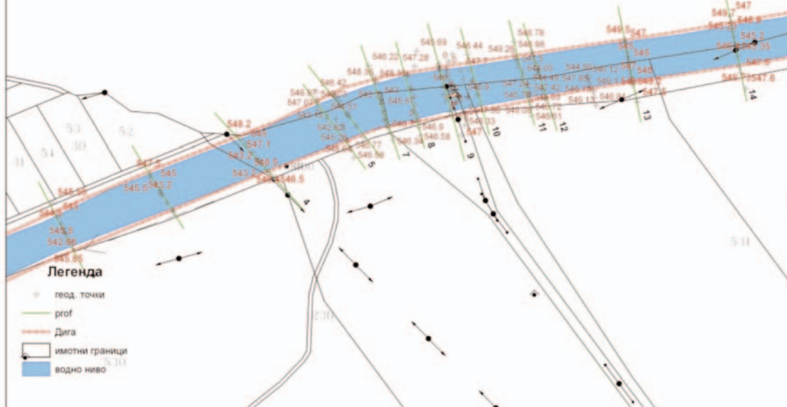
Фиг. 4. Тематична карта с генериран векторен слой водно ниво получено при нормативно зададено водно количество с обезпеченост 5 % с изградени диги
