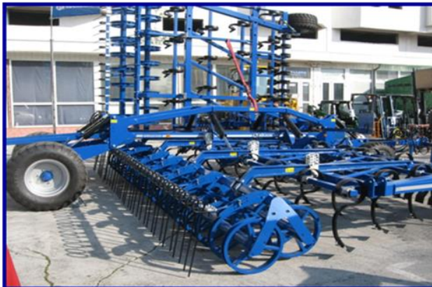
Poza 3 - Agregat combinat afinare + nivelare
