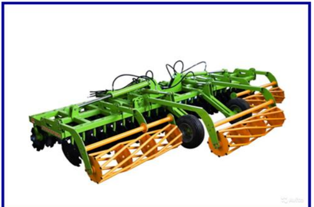
Poza 4 - Agregat combinat discuire + nivelare
