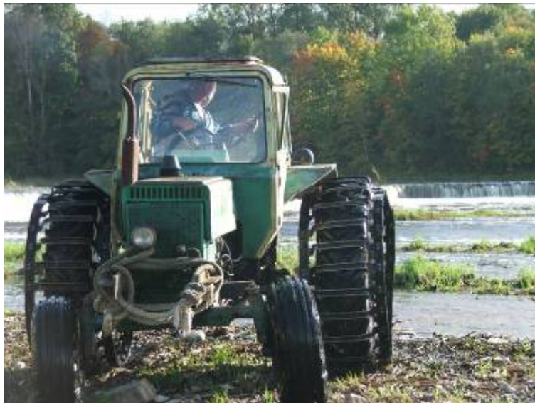
Darbam Ventā, kuras dolomīta gultni ar asām dolomīta atlūzām vietām klāj līdz 40 cm biezs sanesumu un sedimenta slānis, labākas saķeres ar gultni nodrošināšanai riteņu traktora riteņi ir aprīkoti ar metāla aplikām
