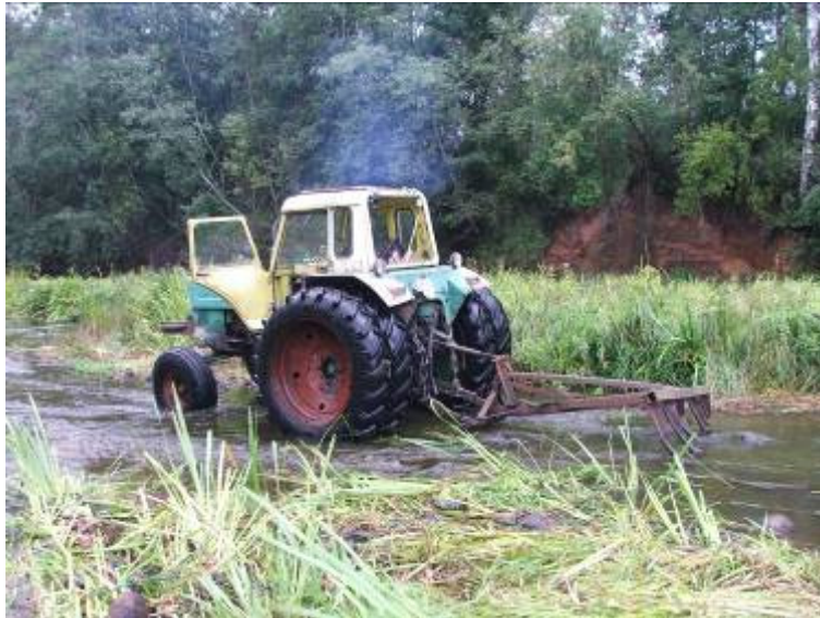
Darbam Jaunupē un Salacā, kuru gruntis veido liela izmēra akmeņi, riteņu traktors ir aprīkots ar dubultiem riteņiem
