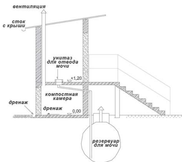
**Рис. 4.8.** Туалет, построенный в деревне Гужули, состоит из 3-х сдвоенных “сухих” туалетов и одной комнаты с 3 писсуарами без смыва водой и 2-х емкостей для хранения мочи, объемом 2 м<sup>3</sup> каждая. 165 учеников (7-17 лет) пользуются туалетом (идея “СТ” разработана ТУНН).
