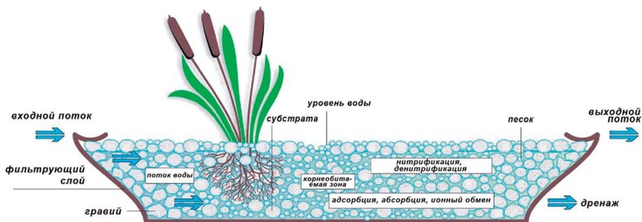
**Рис. 4.3.** Поперечное сечение построенного вэтлианда
