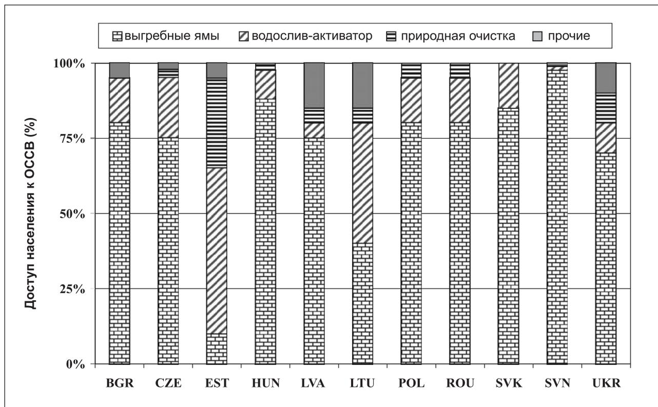
Рис. 2.7. Соотношение методов очистки сточных вод в сельской местности
