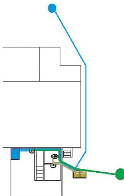
**Рис. 4.10.** Системы водоснабжения и “серых вод” школы в селе Бобрик. 36 учеников и 16 преподавателей пользуются туалетом (линия синего цвета – подача водопроводной воды, линия зеленого цвета – подача технической воды, линия оливкового цвета – отвод “серых вод”), разработанным неправительственной организацией “МАМА-86”
