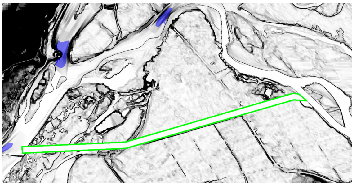
Figura 19: Masa zbutëse e skenarit të analizuar për përmirësimin e sigurisë nga përmbytja e urës Bahcallek - kanali shtesë i devijimin e përmbytjes.
