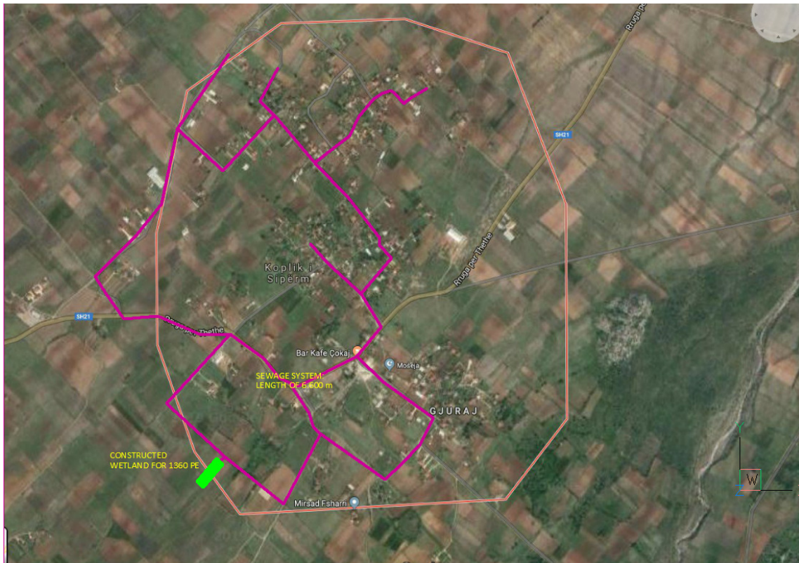
Figura8: Skema e sistemit të kanalizimit me ITUN të vogël autonom në fshatin Koplik i Sipërm
