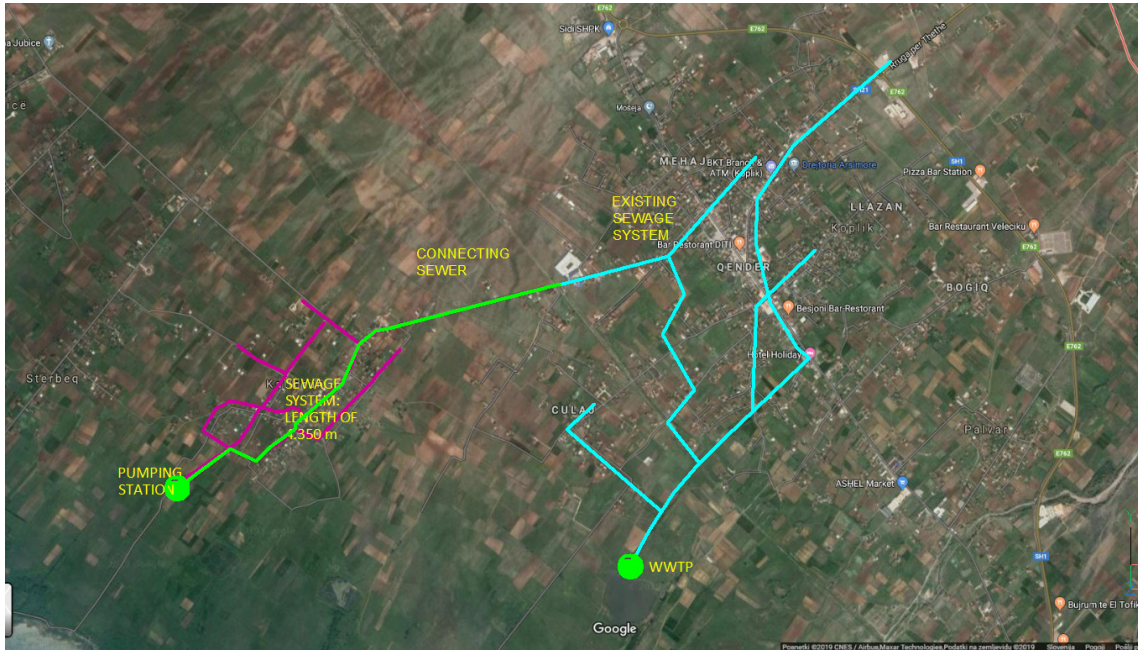
Figura 5: Skema e kanaleve të ujrave të zeza me ITUN në fshatin Koplik
