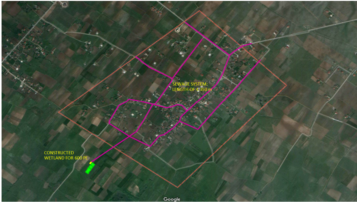
Figura 3: Skema e sistemit te ujrave te zeza me ITUN te vogel ne fshatin Kalldrun
