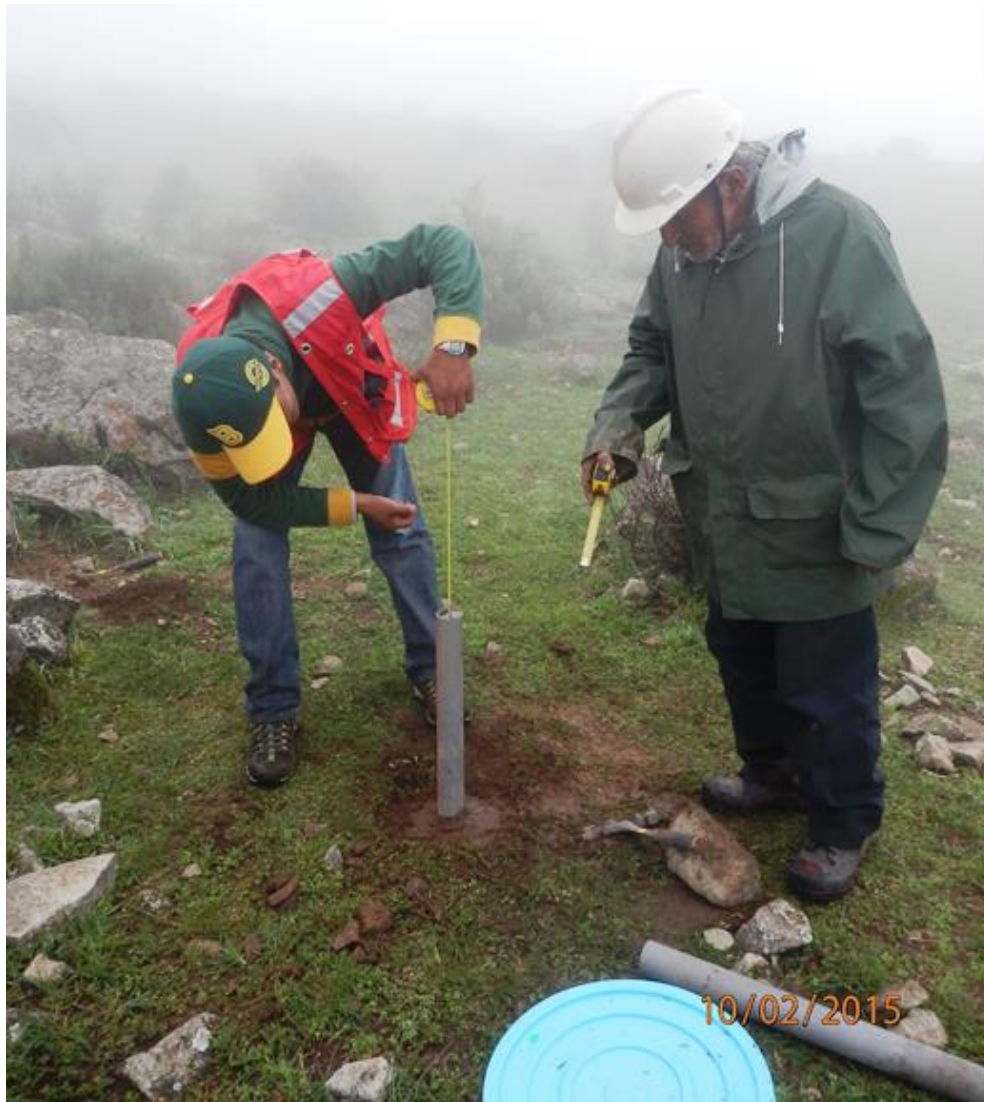
Fotografía 7 Ensayo de Infiltración EI-08 con características semipermeables, nótese los materiales de limo arcilla.
