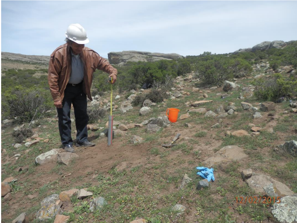
Fotografía 9 Ensayo de Infiltración EI-01 ( K=1.386 m/día), nótese los materiales de limo arcilla y arena con esporádicos clastos de rocas volcánica, con Características permeables.
