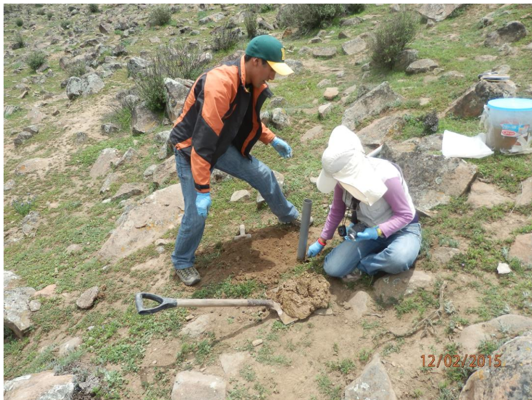
Fotografía 10 Ensayo de Infiltración EI-03 con características de algo a poco permeables ( K: 3.30 \times 10^{-1} m/día), nótese los materiales limo arcillosos de la matriz fina.
