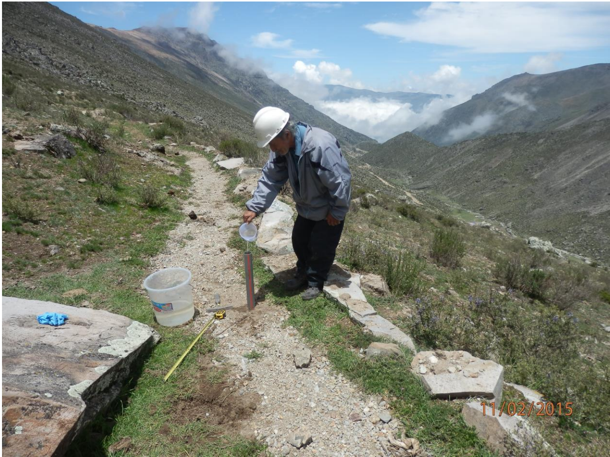
Fotografía 8 Ensayo de Infiltración EI-06 con características permeables ( K: 1.811 \text{ m/día} ), nótese los materiales gravosos en la base de un antiguo canal, la misma que proponemos recuperarla y ponerla al servicio de la recarga artificial.
