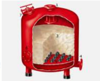
රූපසටහන: වැලි මාධ්‍ය පෙරණ (Sand Media Filter)
