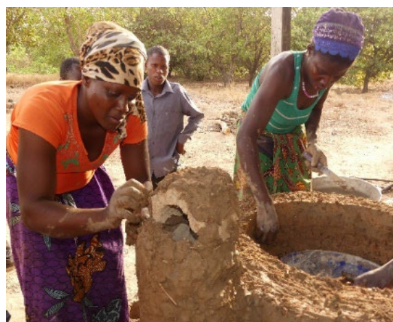
Photo 2.4.2.4b. : Formation des artisans et monitrices sur la fabrication des foyers améliorés
