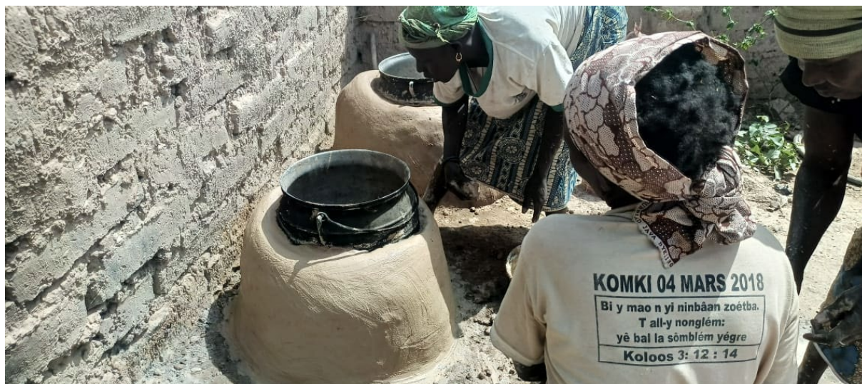
Photo 2.14.2.1. : Fabrication de foyers économiques avec les élèves du Lycée de Komki Ipala
