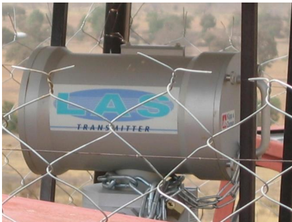
Scintillometer: heat flux
